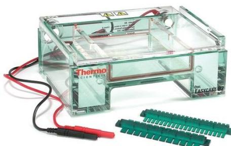
Εικόνα 24 – Τυπική συσκευή ηλεκτροφόρησης πηκτή
